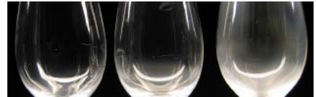
Angrepp på vinglaskupor från basiskt diskmedel.
